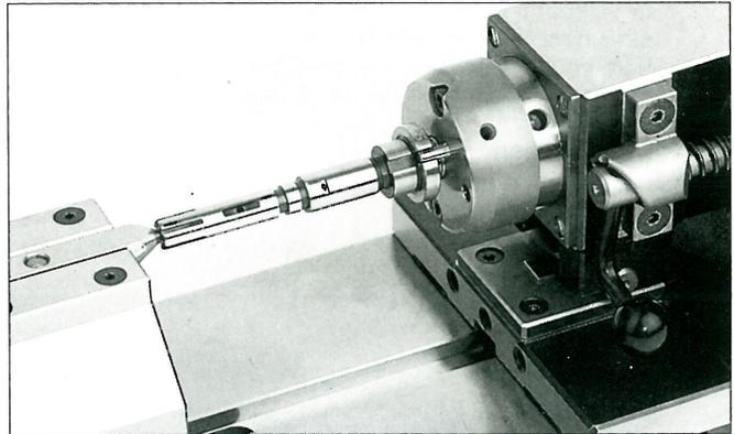
Teilapparat DELTA mit Grundplatte und Reitstock. Einschließlich spezieller Sonderaufnahme zum Senkerodieren.
